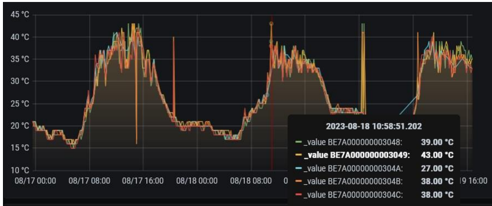
Izmjerene temperature u kućištu senzora IoT-polje u kolovozu
